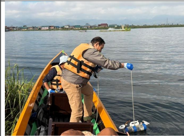
Niskin Sampler အသုံးပြု၍ ရေအရည်အသွေး ကွင်းဆင်းတိုင်းတာခြင်း
